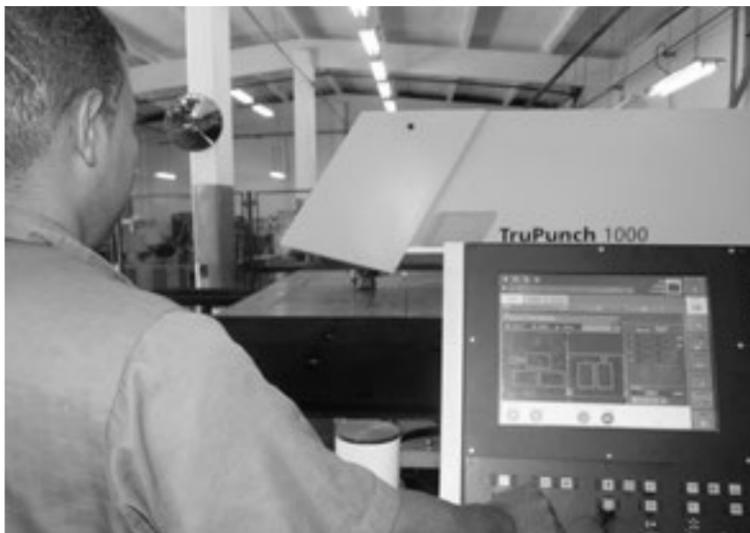
La máquina multipunchadora operada por Yohandris González genera una alta precisión en la construcción de las piezas.
