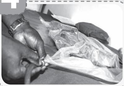
Colocación del fusil en la funda de nailon con todos sus agregados para proceder con la conservación al vacío
