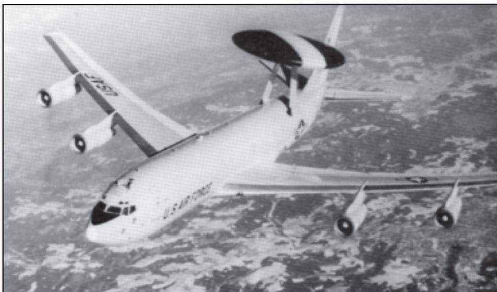
*Los E-3A basificados en Manta, permiten monitorizar señales de radar, así como comunicaciones telefónicas y de radio en un área de doscientas millas.*
