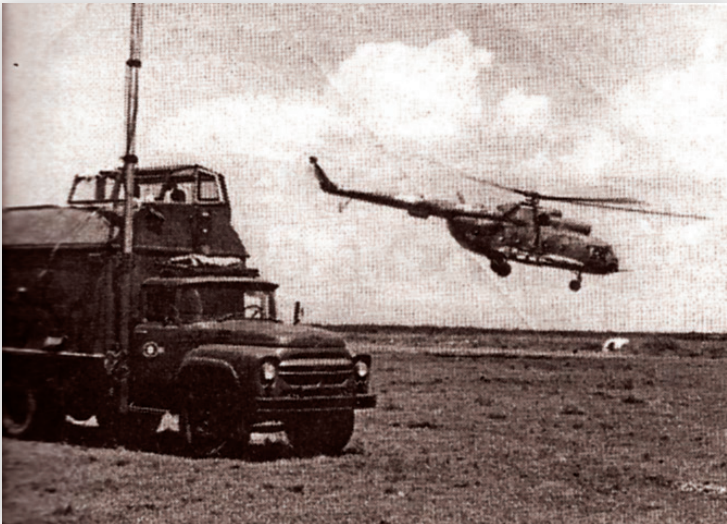
Vehículo CKP-9 en misión de combate. En la parte superior se observa la cabina para la dirección de los vuelos.
