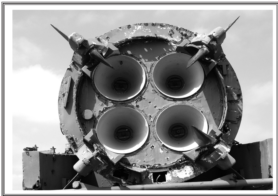
Fig. 4 Toberas de las cuatro cámaras de combustión en el cohete R-12.
