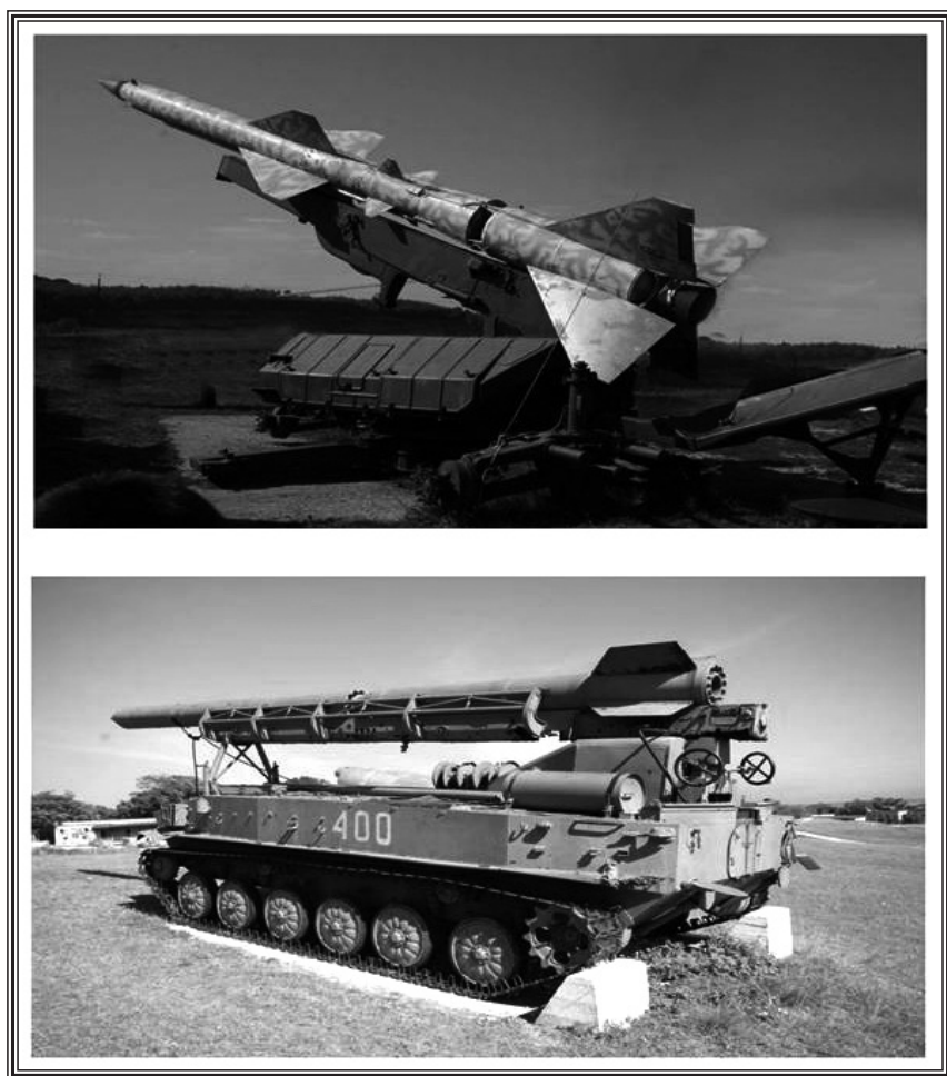
Fig. 9 Cuadro superior: cohete antiaéreo del sistema SA-75, en su rampa de lanzamiento; cuadro inferior: proyectil táctico balístico tierra-tierra del tipo Luna.
